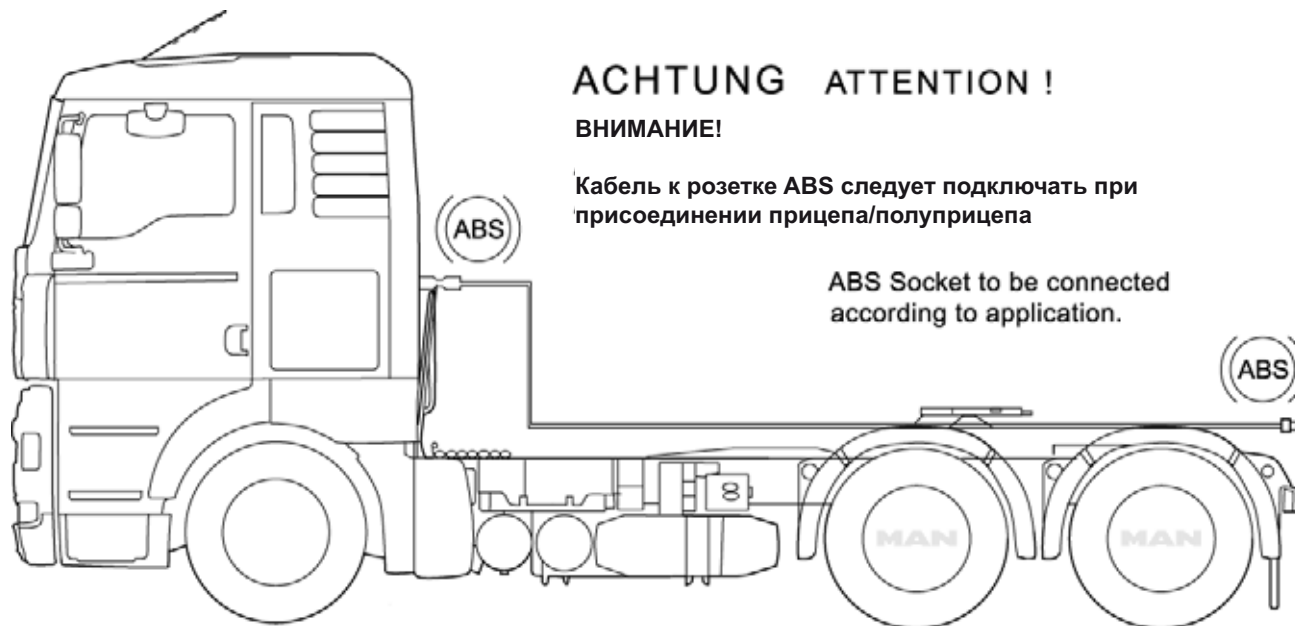
Рис. 3: Подключение соединительного кабеля ABS
