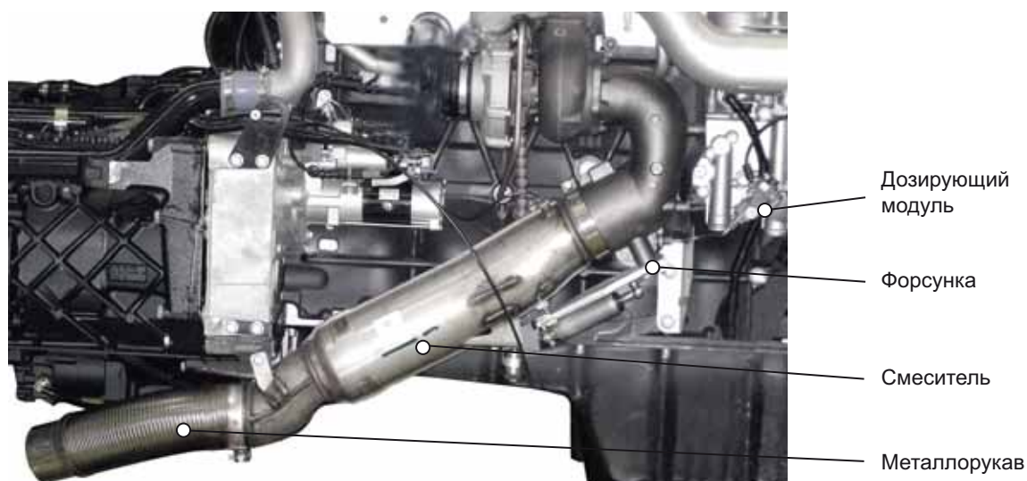
Рис. 51: Выпускной тракт от смесителя до металлорукава TDB-426
