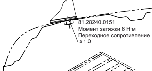
Рис. 91: Места для установки антенн TDB-560
