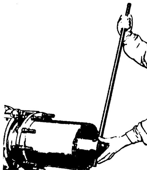
Рис. 20. Сборка соединителя
